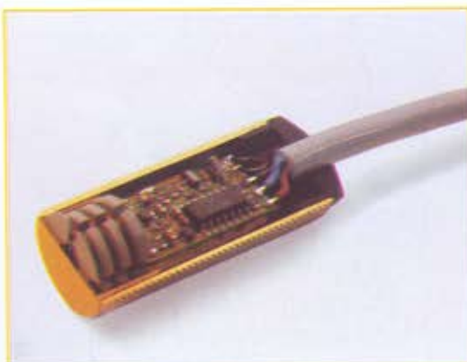
Fig. 2. Principiul diferențial îmbunătățește considerabil caracteristicile senzorilor inductivi
